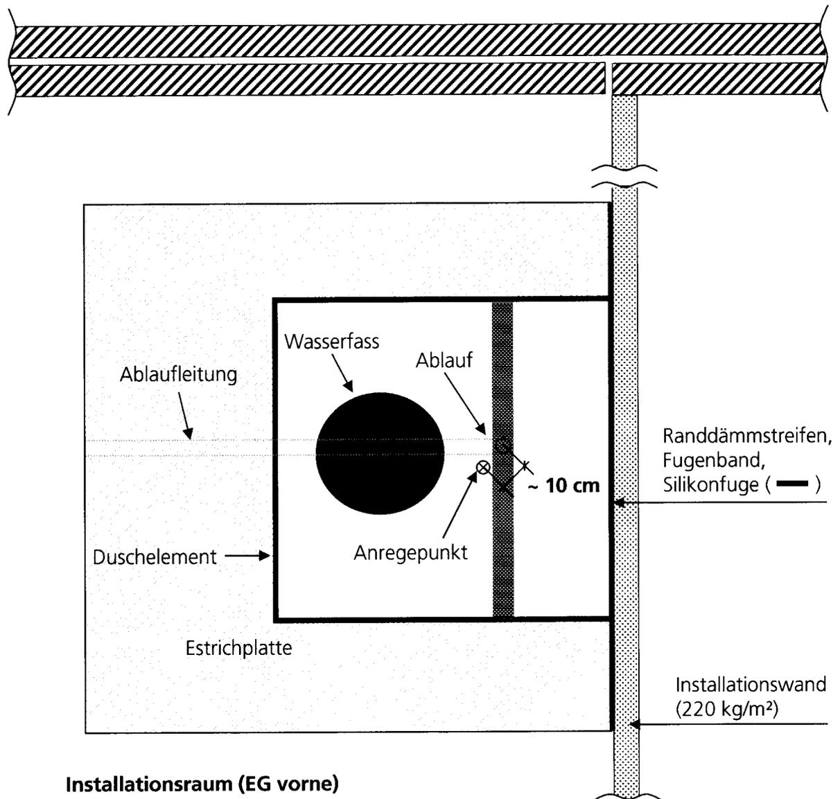
Lage des Prüfaufbaus im Installationsraum (EG vorne).
